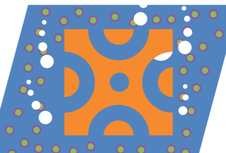
[B] Sottovuoto l'aria fuoriesce dai pori
